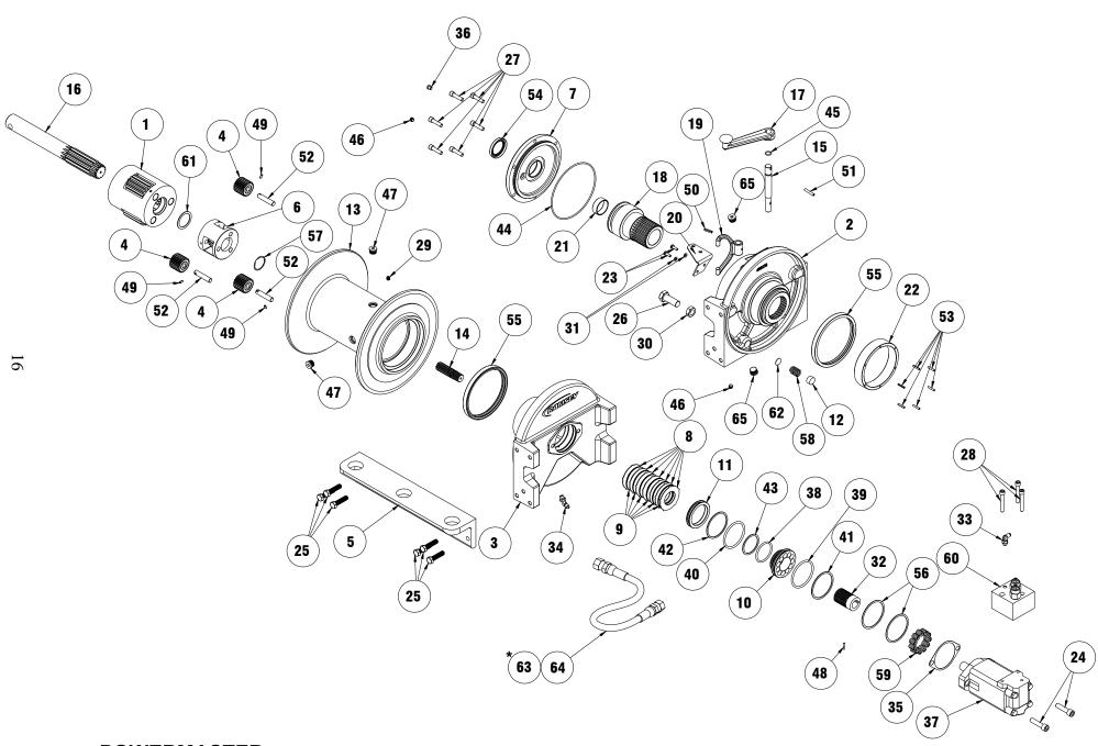
POWERMASTER 20K BUMPER WINCH \* CONFIRM MOTOR PORTS UP OR MOTOR PORTS DOWN FOR CORRECT HOSE ASSEMBLY
